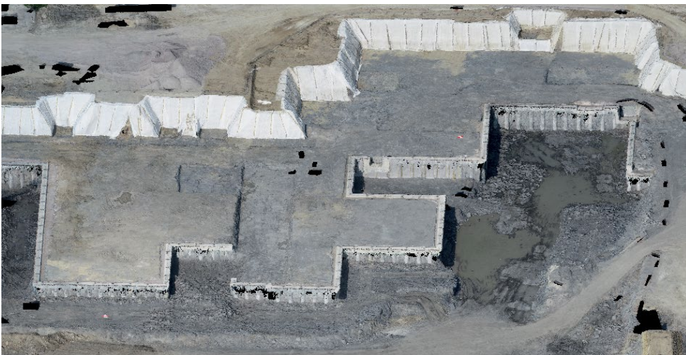
Ausschnitt bereinigter Punktwolken, Projekt: Erdbauarbeiten Neubau der Klinik am Eppert, Göppingen (© LEONHARD WEISS GmbH & Co. KG)
